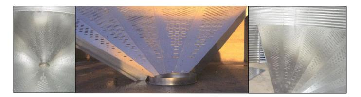
Eine Erhöhung des Konusauslaufs in der Mitte ermöglicht eine Entnahme unterhalb vom Konus mit einer Schnecke oder einem Trogkettenförderer.
