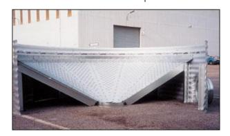
Die Belüftungskonen sind lieferbar für Silodurchmesser von 2,68 m bis 13,33 m und bis zu Silohöhen von 20,66 m.
