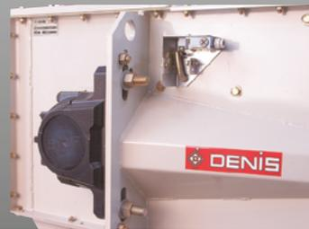
Fußelement mit Spannstation für Kette
